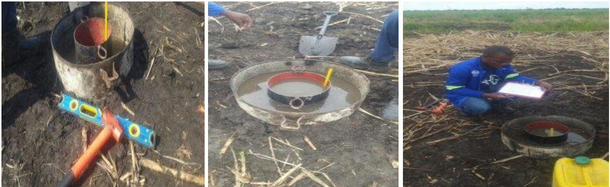
Figura 13: Medição da infiltração no solo
